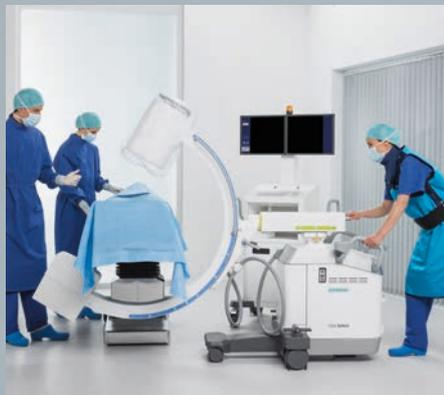
Posicionamiento fácil y preciso del brazo en C con ejes y frenos codificados por colores
